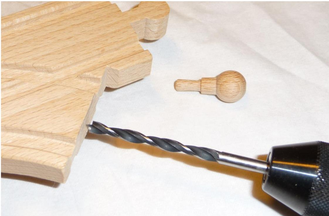
Abgebrochene Teile können durch passende Ersatzteile ersetzt werden.
