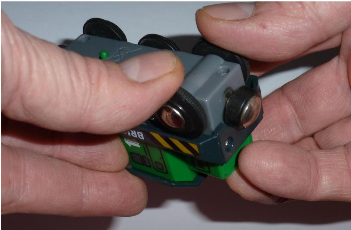
Antriebsachs testen: Räder und Reifen in verschiedene Richtungen drehen
