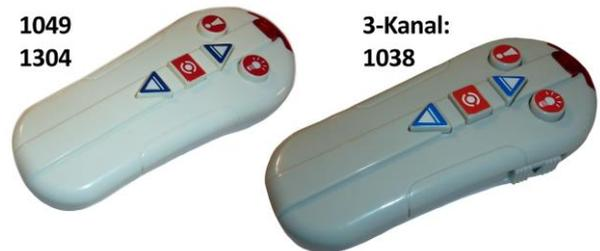
Die drei einstellbaren Frequenzen der 1038 überlappen nicht mit denen der anderen Loks. Es ist also möglich, eine 1038 mit entweder einer 1049 oder einer 1304 parallel zu betreiben. Ebenso kann man bis zu drei 1038 gleichzeitig fahren lassen, sofern genügend Platz dafür vorhanden ist.
