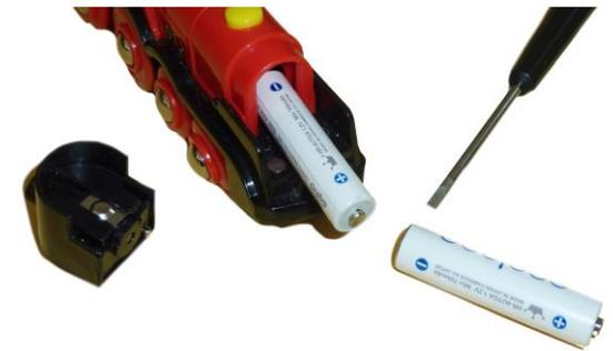
Funktioniert die Lok nach dem Einlegen neuer Batterien nicht, die Batterie überprüfen, ob sie richtig eingelegt sind (beide mit dem Minus-Pol nach innen). Auch bei neuen Batterien kann eine defekte dabei sein. Bei fehlender Funktion die Batterien einzeln mit einem Batterietester prüfen, insbesondere bei gebrauchten Batterien oder Akkus, da deren Ladezustand sehr unterschiedlich sein kann.
