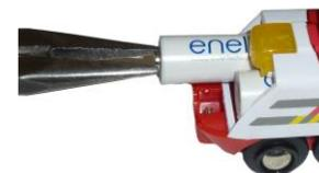
Beim Batteriewechsel sind eingelegte Batterien oft schwer zu greifen. Auf keinen Fall versuchen, die Batterie heraus zu schütteln oder zu schlagen. Dabei besteht die Gefahr, dass die Kabel im Gelenk zwischen den beiden Lok-Teilen brechen. Besonders Akkus sind manchmal geringfügig dicker als normale Batterien und sitzen fester. Diese mit einer Flachzange herausziehen. So hält man Schäden von Lok und Batterien fern.
